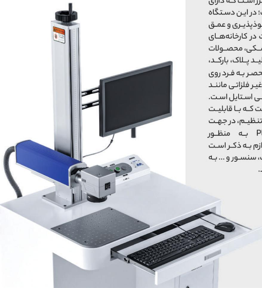
دستگاه حکاکی فلزات یکی از دستگاه‌های بسیار پرکاربرد در صنعت است که به منظور حکاکی در دو مدل دسکتاپ و پرتابل عرضه می‌شوند. فرایند حکاکی لیزری در این دستگاه‌ها از طریق طراحی در کامپیوتر و بدون دخالت دست از طریق پرتو لیزر انجام می‌شود که اثر دائمی و پایداری دارد.
